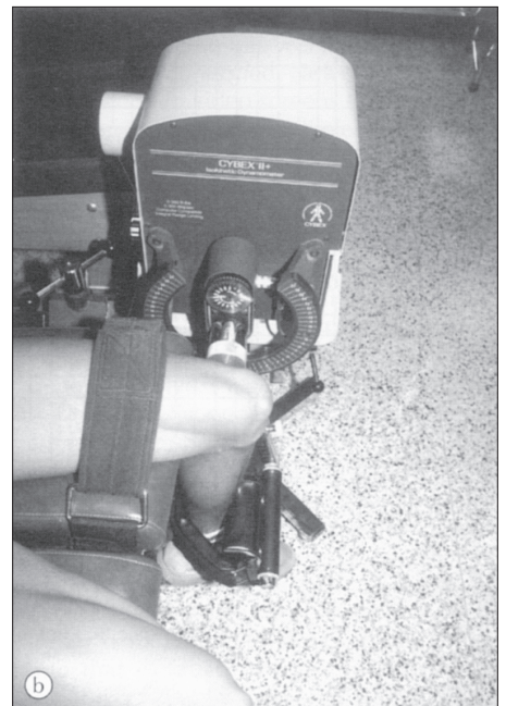
Slika 1: (a) Ocena delovanja kolenskega sklepa s pomočjo izokinetičnega dinamometra Cybex. (b) Pred testiranjem je treba ročico, ki meri navor, uravnati tako, da je vzporedna s kolensko osjo. V (b) je levo koleno pokrčeno do pravega kota. Z iztegovanjem, ki se začne v (a), koleno spravimo v iztegnjeni položaj (upogib je 0^\circ ).
