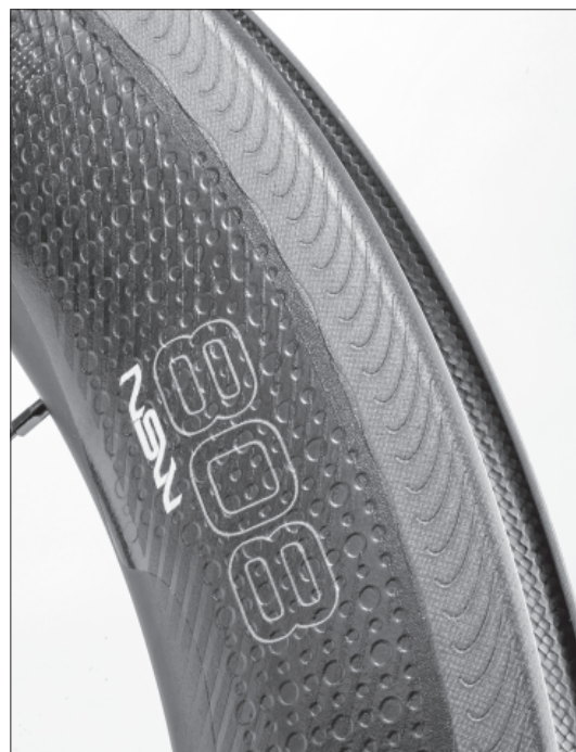
Slika 2: Konstrukcijska rešitev proizvajalca Zipp z "jamicami"
